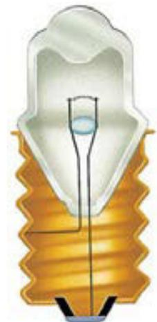
**Figura 11-6** Dibujo esquemático que muestra la trayectoria de conducción continua a través de un bombillo.
